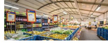
La toiture est équipée de toiles blanches opaques et est liée au système de gouttières intégrées. Celui-ci permet d'évacuer l'eau de pluie et de maintenir les toiles tendues. L'Alure Globe est équipée de façon standard d'un système de plancher cassette en bois, posé sur longrines.
